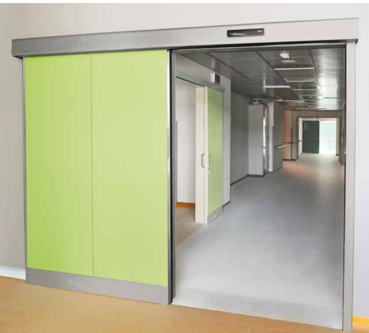
steel collection Art. 11S porta scorrevole motorizzata motorized sliding door laminato - laminate finishing SP. TH. 9/10 protezione di battuta - edge protector PS 801 battipiedi - kick plate PX 030 cassa in acciaio inox - stainless steel doorframe SP. TH. 15/10 Mod. Rapid
